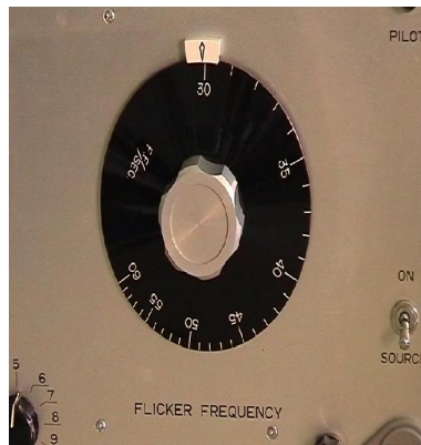
Foto 2. Regulador Frecuencia de parpadeo a 30hz
